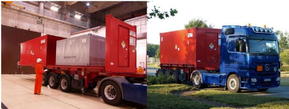
Abbildung 1: Geöffneter Transportcontainer mit Abfallgebinde für LKW-Transporte zum LoK, LKW mit Sattelaufleger
